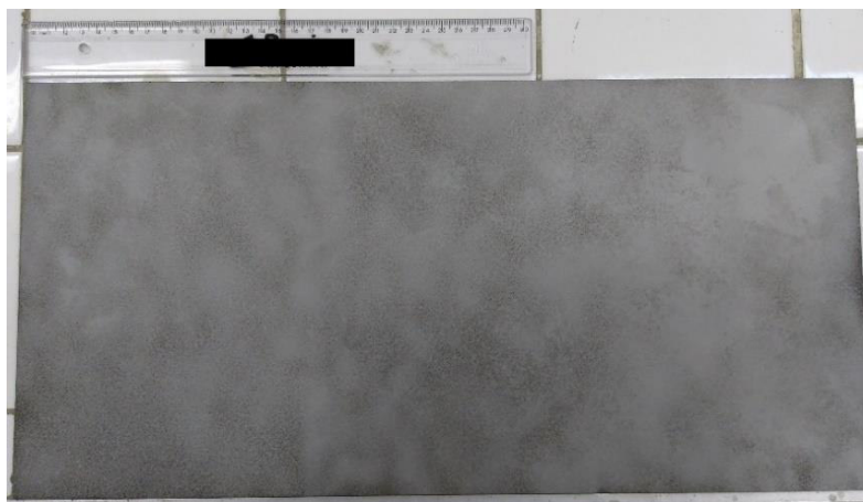
Figura 9 — Chapa de aço comercial utilizada para preparação dos corpos de provas após o processo de jateamento com areia.
