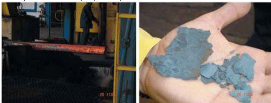
Figura 3 — Carepa formada na superfície do aço (à esquerda); e carepa já excluída do aço por processo de remoção (à direita).
